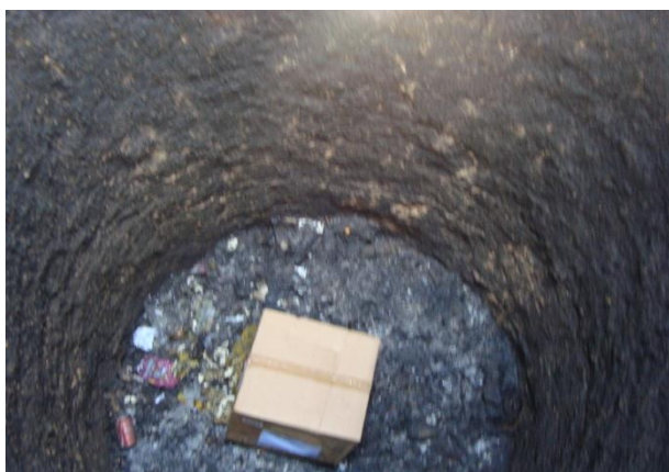
Foto 180: Detalhe do forno onde são incinerados os resíduos sólidos de saúde.
